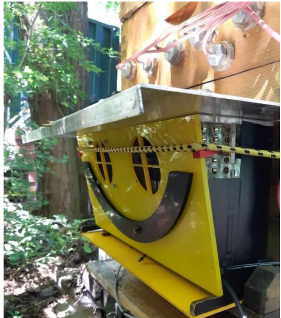
Abb.1: Mithilfe der Fluglochkamera „Bee-o-Meter“ wird die Anzahl der Bienen, Drohnen oder Königinnen registriert, die den Stock verlassen bzw. zurückkehren.
