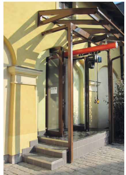
Ein Kran erleichtert nun den Transport schwerer Tierkörper in die renovierte und modern ausgestattete Sezierhalle.
