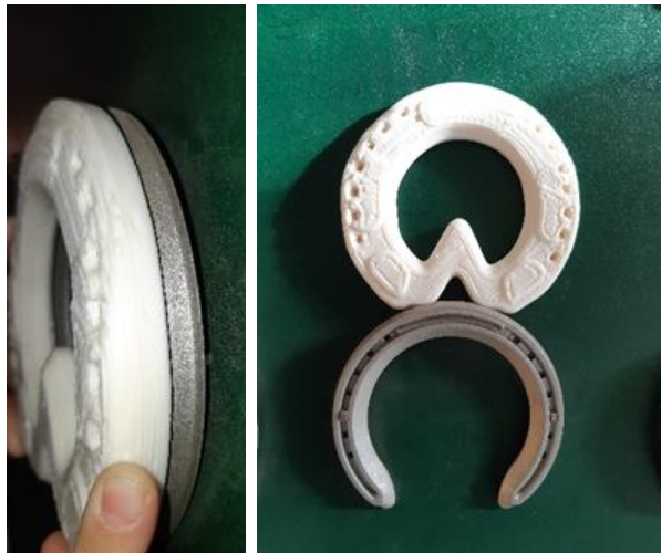
Abb. 12: eigene Fotos eines Standardbeschlages für die Vorderhufe zum Vergleich des gedruckten Beschlages mit der Vorlage. Links: der gedruckte Beschlag auf der Vorlage aufliegend, um zu zeigen, dass die Außenkontur deckungsgleich ist. Rechts: beide Beschläge im direkten Vergleich der Form und der Nagellochanzahl.
