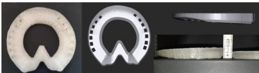
Abb. 14: Links: 3D gedruckter Beschlag zur Entlastung der TBS; oben Mitte und rechts: 3D Ansicht im Shoemakerprogramm (The New Century horseshoes & fittings ltd.®, Dublin, Ireland); unten rechts: Höhenvergleich mit Maßstab zur Darstellung der Trachtenerhöhung um 6 mm (eigene Bilder)
