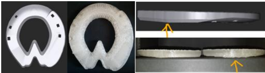
Abb. 20: Links die 3D Ansicht des konstruierten Beschlags im Shoemakerprogramm (The New Century horseshoes & fittings ltd.®, Dublin, Ireland) für die lateromediale Imbalance. Daneben der gedruckte Beschlag, rechts von der Seite im 3D Modell im Shoemakerprogramm (The New Century horseshoes & fittings ltd.®, Dublin, Ireland) und am gedruckten Beschlag. Mit dem orangen Pfeil jeweils der Höhepunkt des 2 mm Keils markiert (eigene Bilder)
