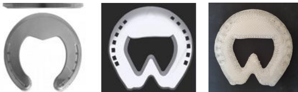
Abb. 15: links der Denoixbeschlag aus Aluminium als Beispiel (The Horseshoe Barn 2020). In der Mitte die 3D Ansicht im Shoemakerprogramm (The New Century horseshoes & fittings Ltd.®, Dublin, Ireland) von der Konstruktion und rechts eigenes Foto des gedruckten Denoixbeschlags.
