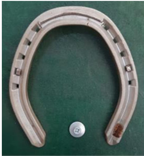
Abb. 21: Hinterhufeisen als Vorlage für drei Testbeschlge (eigenes Bild)
