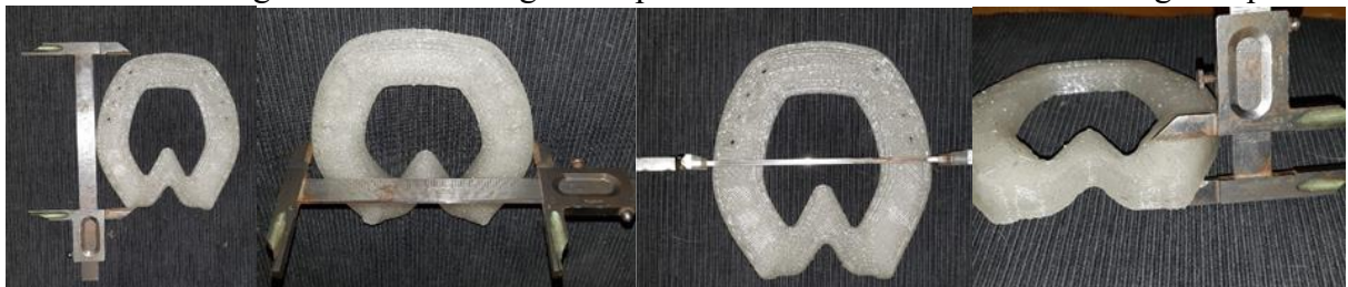
Abb. 10: Messungen mit einer Schublehre von Länge, Breite, und Spezialanforderung (Keil) eines mit dem Shoemakerprogramm (The New Century horseshoes & fittings ltd.®, Dublin, Ireland) hergestellten Beschlags (eigenes Bild)
