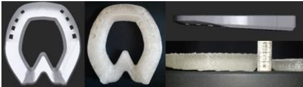
Abb. 23: Spatbeschlag. Links: Die 3D Ansicht des Beschlags im Shoemakerprogramm (The New Century horseshoes & fittings ltd.®, Dublin, Ireland), daneben das gedruckte Resultat. Rechts oben: Seitenansicht im Shoemakerprogramm (The New Century horseshoes & fittings ltd.®, Dublin, Ireland), darunter Seitenansicht des gedruckten Beschlags im Vergleich der Schenkelhöhen im Trachtenbereich mit einem Beschlag ohne Erhöhung (eigene Bilder)
