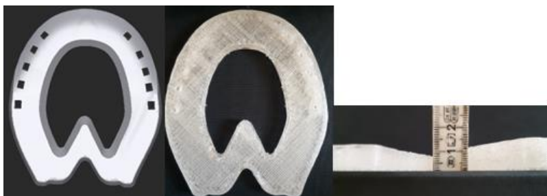
Abb. 22: Standardbeschlag Hinterhufe. Links: 3D Modell des Beschlags im Shoemakerprogramm (The New Century horseshoes & fittings ltd.®, Dublin, Ireland). Mitte: gedruckter Beschlag. Rechts: Unterschied in der Dicke aufgrund eines frhzeitigen Druckabbruches (eigene Bilder)
