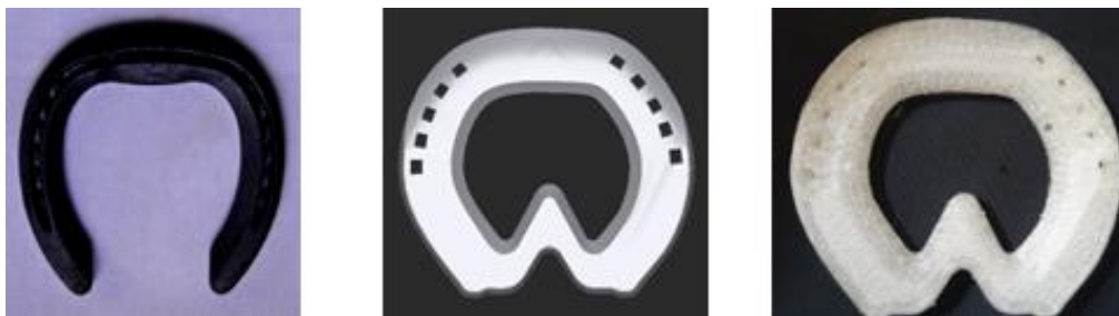
Abb. 13: Links ein NBS Beschlag als Beispiel. Abb. Aus Scherer et al. (2012). In der Mitte die 3 D Ansicht im Shoemakerprogramm (The New Century horseshoes & fittings ltd.®, Dublin, Ireland) und rechts das gedruckte Resultat (eigene Bilder)
