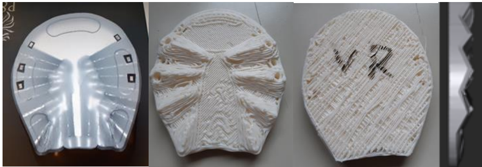
Abb. 30: Beschlag für den rechten Vorderhuf. Von links nach rechts: die 3D Ansicht des Beschlags im Shoemakerprogramm (The New Century horseshoes & fittings ltd.®, Dublin, Ireland) mit der Platte und den aufgesetzten Keilen. Der Beschlag von der Bodenfläche und der Huffläche. Man erkennt die lockere Struktur. Ganz rechts ist der Beschlag von der Seite fotografiert, die Keile ermöglichen ein Schweben der Hufspitze mit vollständig geschützter Sohlenfläche (eigene Bilder)
