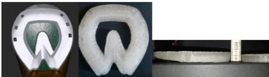
Abb. 17: Podotrochlosebeschlag. Links: 3D- Ansicht im Shoemakerprogramm (The New Century horseshoes & fittings ltd.®, Dublin, Ireland) am Hufmodell, man sieht den zurückgesetzten Schuss. Mitte: der gedruckte Podotrochlosebeschlag. Rechts: Der Beschlag ist an der Trachte 5 mm höher als der Vergleichsbeschlag ohne Keil. (Eigene Bilder)
