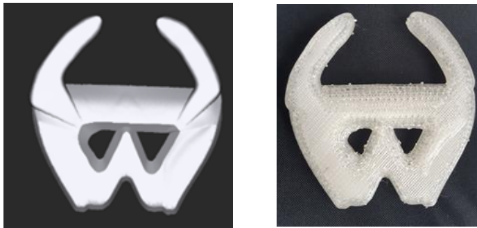
Abb. 18: Links: 3D Ansicht des Beschlags für Hufrehe im Shoemakerprogramm (The New Century horseshoes & fittings ltd.®, Dublin, Ireland). Rechts: der gedruckte Beschlag (eigene Bilder).
