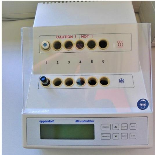
Abb. 5: Eppendorf-Mikrodistillier mit zugehörigem Glasmaterial © Foto von Csernicska Sara
