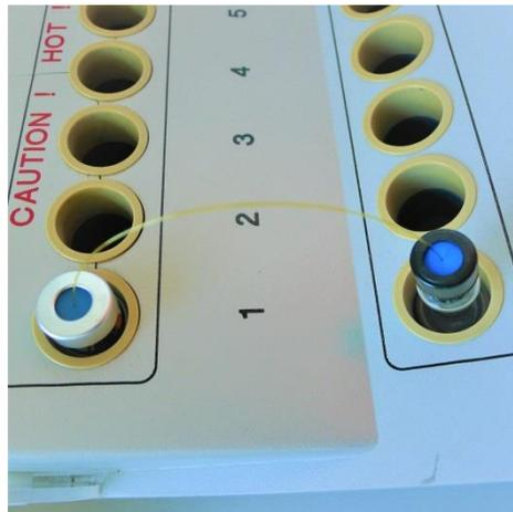
Abb. 6: Befülltes und beheiztes Probengefäß (links) über eine Kapillare (gelb) verbunden mit dem gekühlten Auffanggefäß (rechts). (© Foto von Csernicska Sara)
