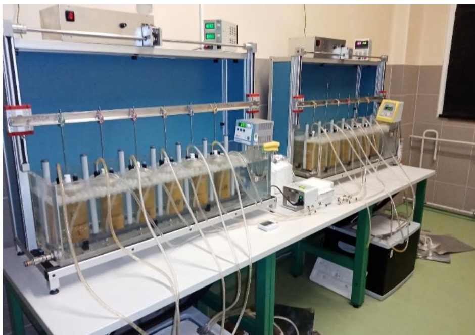
Abbildung 2: Aufbau des Pansensimulationssystems (RUSITEC). © Penagos-Tabares
