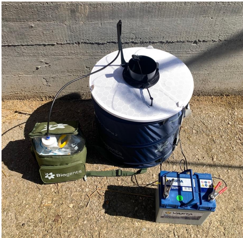
Abbildung 8: Zusammengebaute BG-Sentinel 2 CO 2 Mückenfalle; Isabella Lässer und Maria Rummerstorfer
