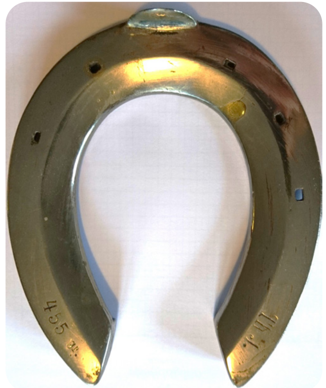
Abb. 5: Tragfläche eines zu Ausstellungszwecken verchromten Pony-Hufeisens (455 g) mit fünf Nagellöchern und durchgehender Abflachung vom Typ Prof. Dr. Lechner (Ausstellung: Jakob Lechner- Der Bachschmiedesohn. 2018. Jakob-Lechnerweg 4, 5071 Wals, Österreich). / Hoof-side surface of a horseshoe for ponies with concave section along the inner edge and five nail holes, type Prof. Dr. Lechner. The horseshoe is chrome-plated. (exhibition: Jakob Lechner- Der Bachschmiedesohn. 2018. Jakob-Lechnerweg 4, 5071 Wals, Österreich).
