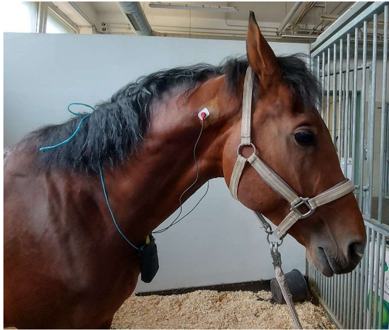
Abb. 6 Beispiel für ein messbereit angebrachtes PainTrace®-Gerät
