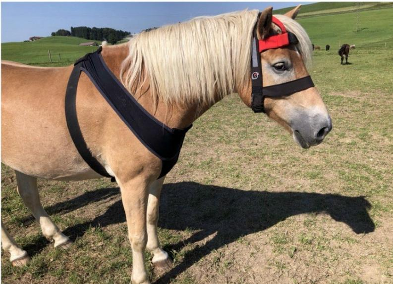
Abb. 1. Pferd ausgestattet mit Trackener®-System (Schwarzer Gurt um den Brustkorb) und Hoofstep®-Sensor am Kopf befestigt mittels Halfter
