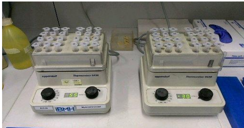
Abb. 3: Inkubation im Thermoblock (der rechte Thermoblock heizt gerade auf)
