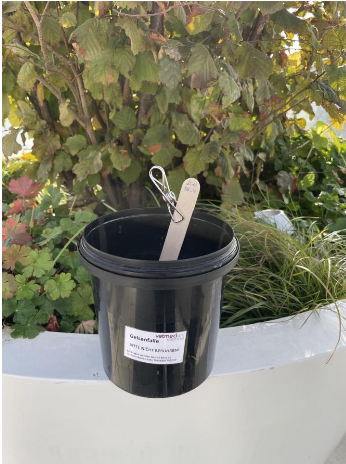
Abbildung 21: Ovitrap bestehend aus Plastikbecher, Holzstab und Metallklammer. Beschriftet mit „Gelsenfalle – BITTE NICHT BERÜHREN!“ und Kontaktdaten
