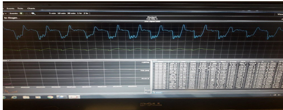
Abb. 2.3: Bei der BWBP aufgezeichnete typische Atemkurve einer Katze mit spontaner Hyperreaktivität der Atemwege; unterhalb sichtbar: ausgegebene Messwerte (inkl. penH)
