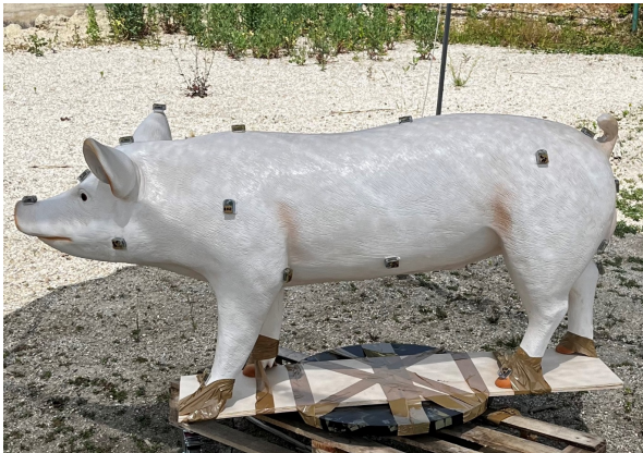
Abb. 9: Seitenansicht des Schweinemodells auf der Drehplattform mit Messgeräten
