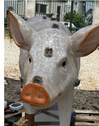
Abb. 8: Kopfansicht des Schweinemodells mit Messgeräten
