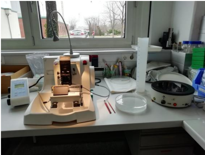
Abbildung 5: Darstellung des Arbeitsplatzes. Mikrotom (links), Wärmebecken (rechts)
