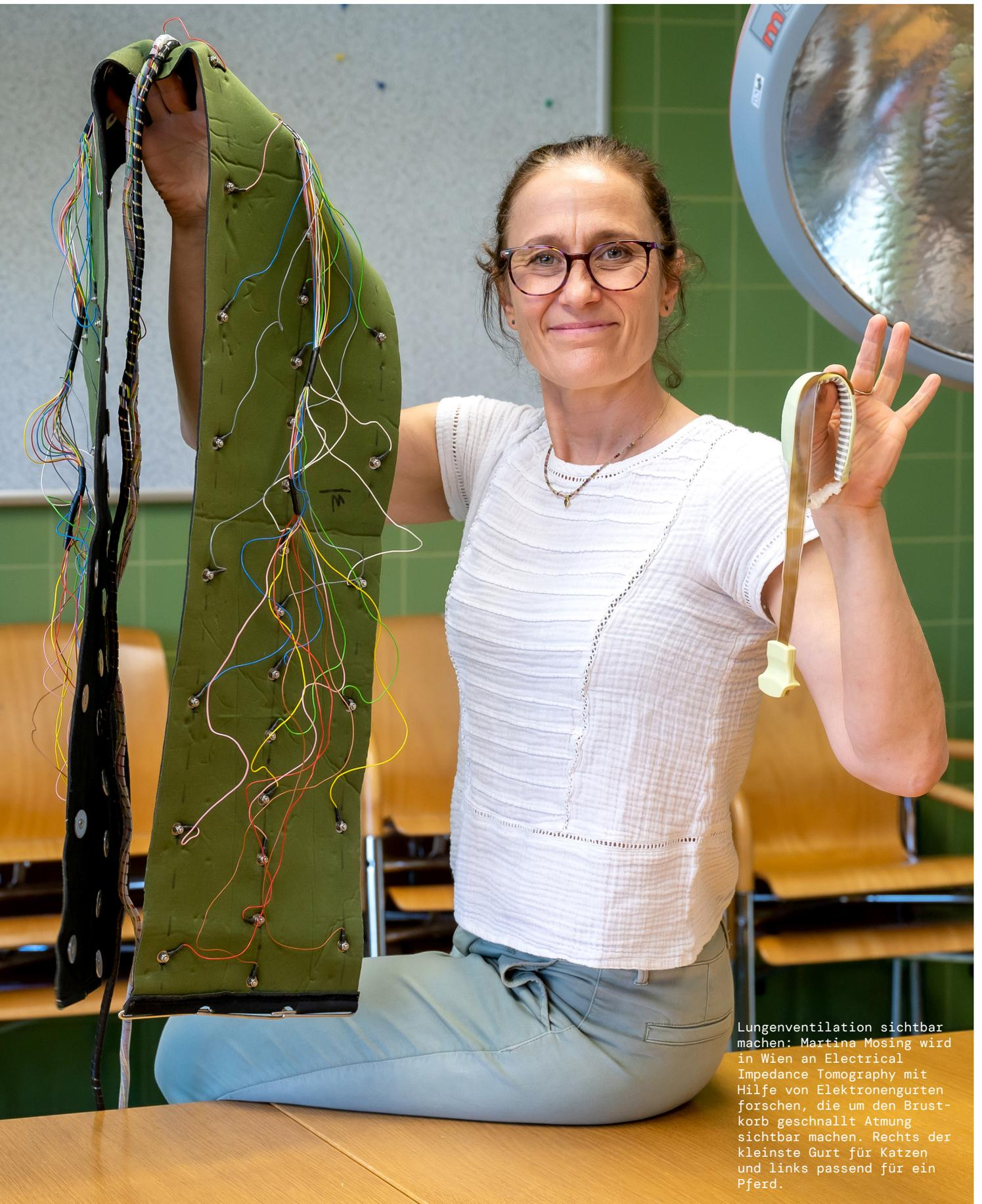
Lungenventilation sichtbar machen: Martina Mosing wird in Wien an Electrical Impedance Tomography mit Hilfe von Elektronengurten forschen, die um den Brustkorb geschnallt Atmung sichtbar machen. Rechts der kleinste Gurt für Katzen und links passend für ein Pferd.
