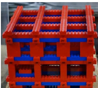
Abb. 10: Kalibrationskubus aus Lego®
