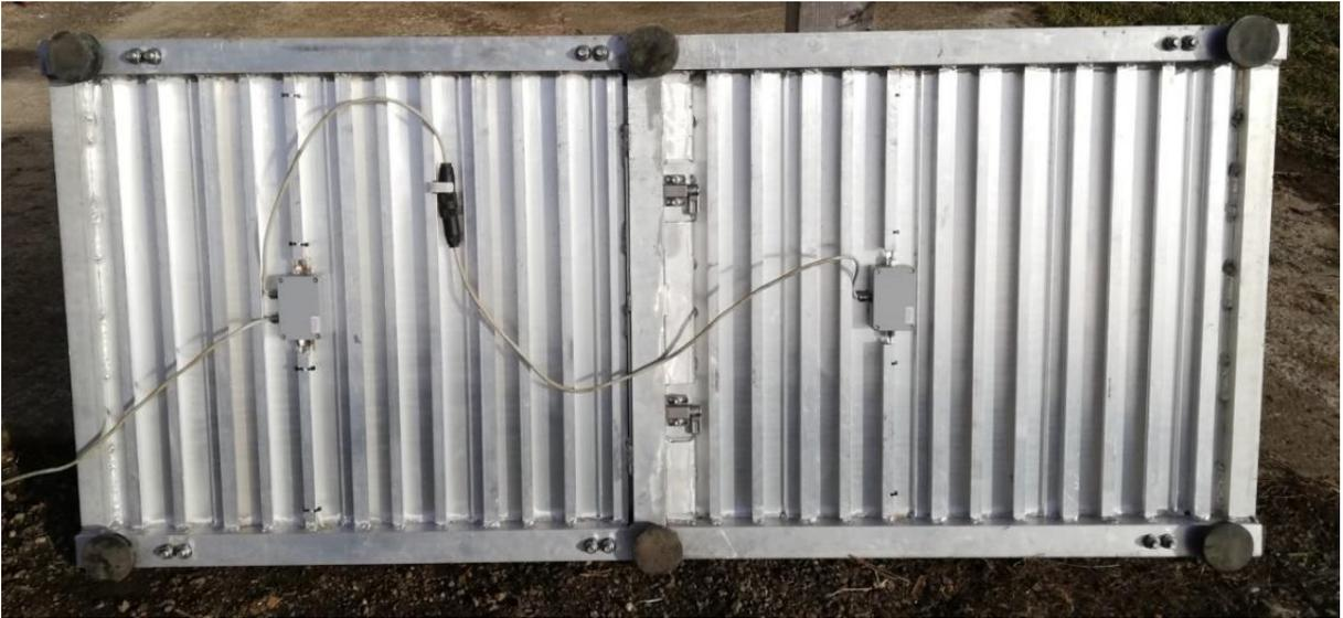
Abb.3: Mobile Pferdewaage (180 cm x 80 cm x 8,5 cm) aus der Perspektive von unten, bestehend aus Aluminium und zwei Teilen, die ineinander verankert werden. An der Unterseite der Waage befinden sich sechs runde Wiegeelemente (Durchmesser 7,5 cm) aus Edelstahl. An einer Hälfte der Waage befinden sich vier Wiegeelemente, an der anderen zwei. Das Kabel (Lycy 7 x 0,25 mm<sup>2</sup>) wird an der Unterseite verbunden, damit alle sechs Wiegeelemente miteinander verrechnet werden.
