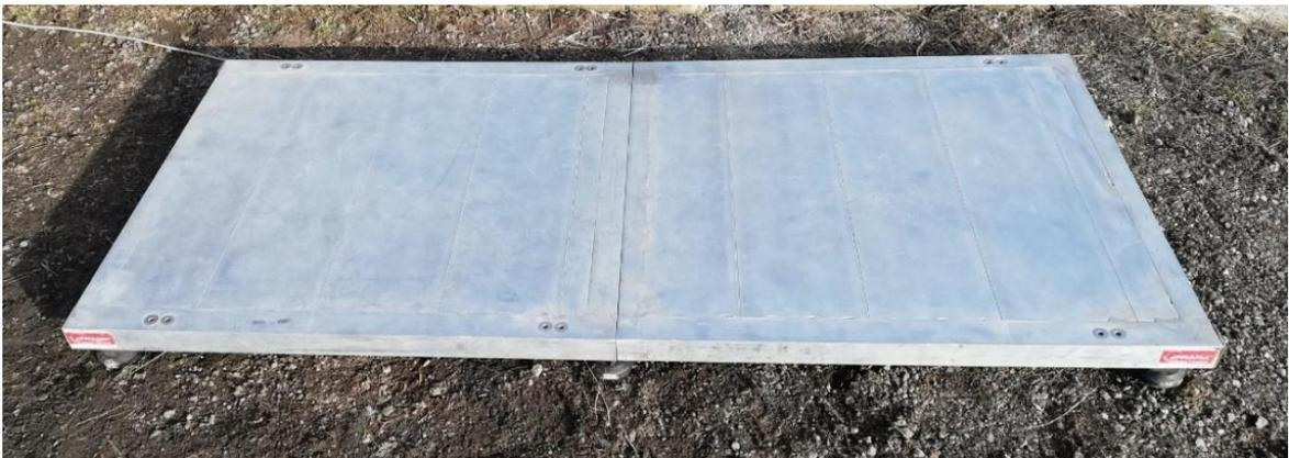
Abb.1: Mobile Pferdewaage (180 cm x 80 cm x 8,5 cm) aus der Perspektive schräg von oben. In Abbildung 1 ist die Waage auf unebenem Untergrund aufgestellt. Dies führte zu ungenauen Messergebnissen.
