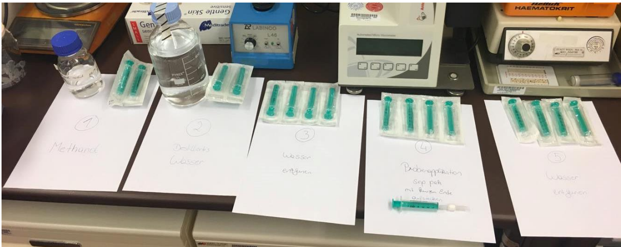
Abbildung 9: Stationen für Probenaufarbeitung, 1: Methanol, 2: Destilliertes Wasser, 3: Wasser entfernen (trocknen), 4: Probenapplikation, 5: Wasser entfernen.
