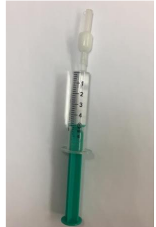
Abbildung 10: Spritze mit Cartridge Sep-Pak C18
