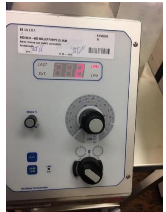
Abbildung 11: Rollerquetschpumpe von Stöckert Instrumente München, Typ: 10-10-00; Fabriknummer: 10H 1496; 220 V ;50 Hz; 1,5 A
