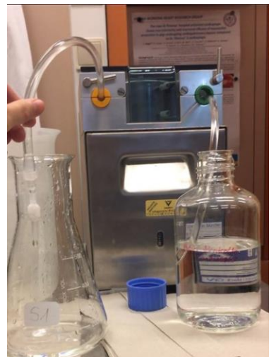
Abbildung 12: Probenapplikation mit Rollenquetschpumpe
