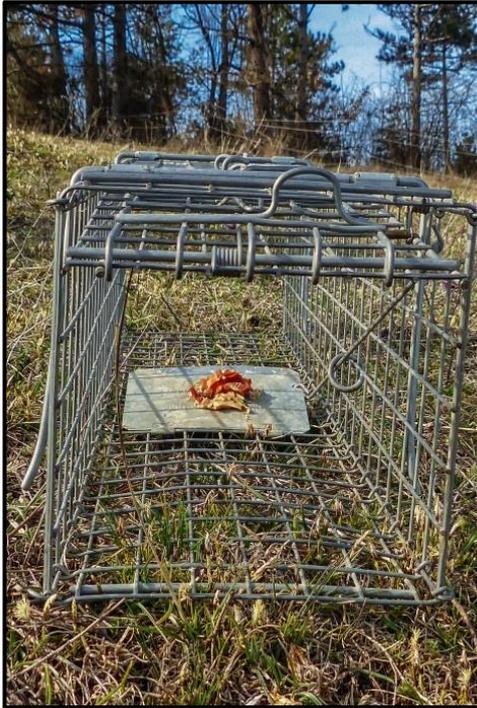
**Abb. 3:** beköderte Drahtwippfalle.
