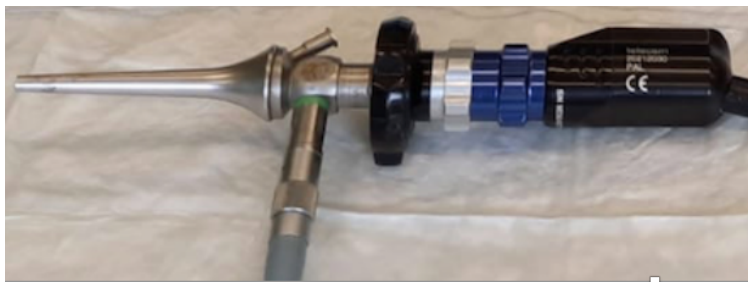
Abb. 8: Klassisches Otoskop mit Kamerakopf für die Videootoskopie ©Dermatologie VetmedUNI
