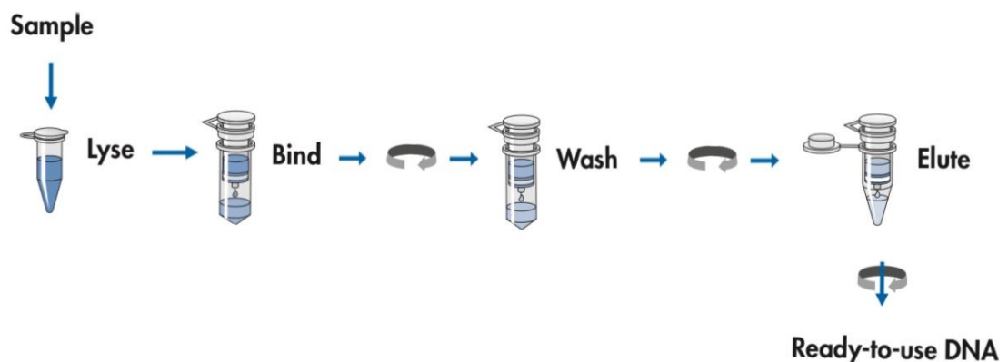
Abb. 6: Prinzip der DNA-Extraktion mittels DNeasy Blood & Tissue Kit (Qiagen, Venlo, Niederlande), modifiziert. ( https://www.qiagen.com/us/shop/sample-technologies/dna/genomic-dna/dneasy-blood-and-tissue-kit/#productdetails , Zugriff 12.04.2019)
