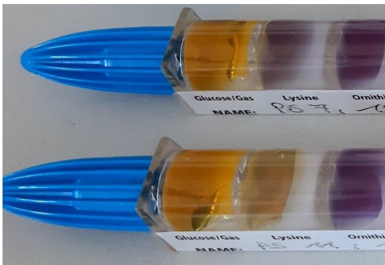
Abb. 3: Lysindecaboxylierung (Ausschnitt vergrößert): in der zweiten Kammer (von links): negative Probe unten (gelb) im Vergleich zu positiver Probe oben (lila)
