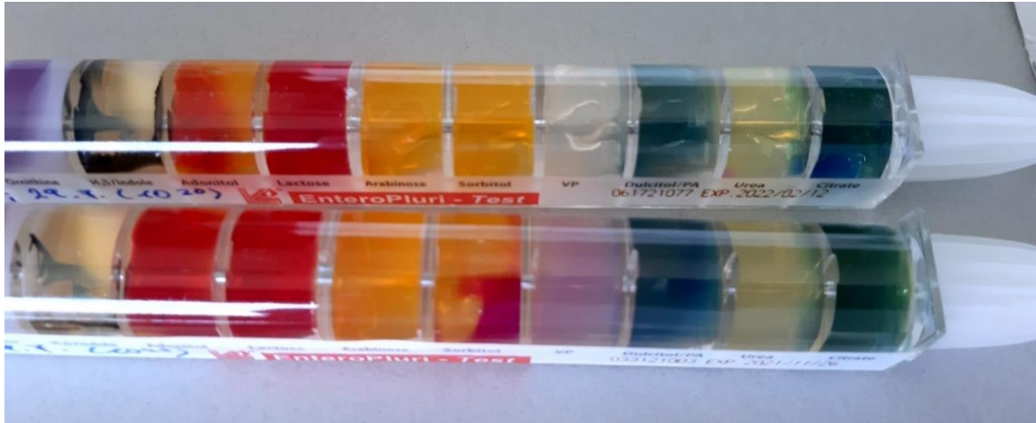
Abb. 2: VP-Reaktion (vierte Kammer von rechts): oben eine negative Probe (farblos), unten eine positive (rosa)
